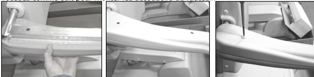
Illustration 1.4 Montage des accoudoirs
